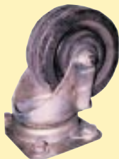
Roulette SKF-Equipements (Réf JSFN 10026152) à la fin des tests
